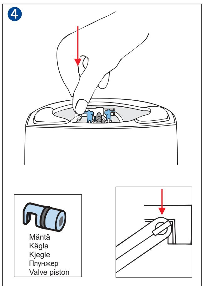
**HUOM !** Tämä venttiili toimii vain, jos säiliönkansi on asennettu ja momenttimutteri kiristetty.
